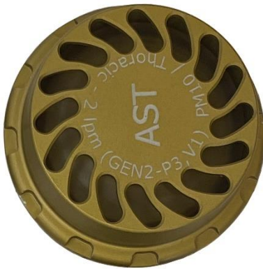
(d) Size-selective inlet PM 10 @ 2 L min -1 (GEN2)
